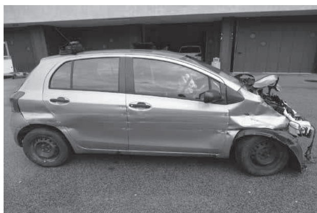
Slika 1. Oštećenja desnoga bočnog dijela vozila Toyota Yaris
